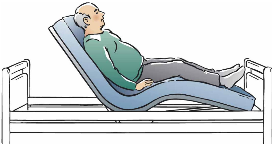
Ved samtidig elevation af sengens lår/bendel mindses fremadgliden i sengen. Og ved at lave "knæ-knæk" mindses trykket på hælene, og liggekomforten forbedres. Bemærk, at liggefladens omdrejningspunkter følger personens knæ- og hoftelod.
